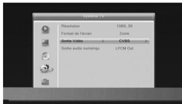
uma imagem em alta definição. Por contra, com um cabo euroconector, ajustar o modo **RGB** já que em resolução standard, este oferece uma melhor imagem na maioria de televisores.
