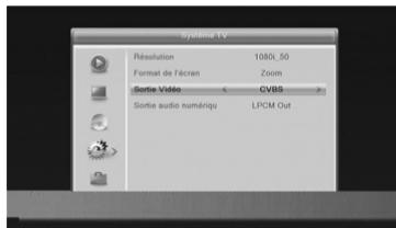
tener una imagen en alta definición. Por contra, con un cable euroconector, ajustar el modo **RGB** puesto que en resolución standard, éste ofrece una mejor imagen en la mayoría de televisores.
