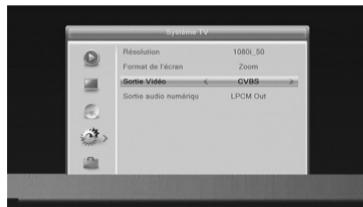
image en haute définition. Par contre, avec un câble périphérique, préférez le mode **RGB** car en résolution standard, celui-ci donne une meilleure image sur la plupart des téléviseurs.
