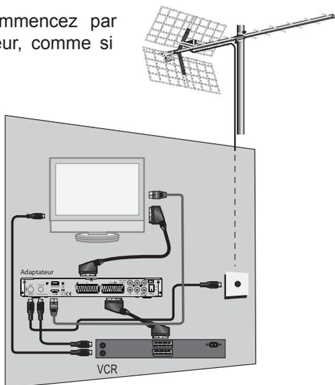
Pour lire une cassette, mettez l'adaptateur en veille puis lancez simplement la lecture de la cassette. Le magnétoscope prendra automatiquement la main sur l'adaptateur. Si ce n'est pas le cas, appuyez sur la touche TV/VCR de la télécommande de votre magnétoscope.
