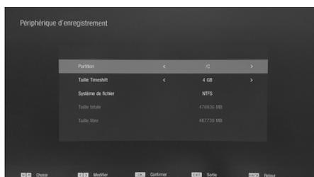
Si votre disque comporte plusieurs partitions, la première utilisable est sélectionnée par le terminal lors de la connexion du disque dur. Vous pouvez changer de partition dans le menu **PVR / Dispositif / Périphérique d'enregistrement**. Si un disque ou une clé n'est pas reconnu, utilisez la fonction de formatage disponible dans le menu **PVR / Dispositif / Formatage**.
